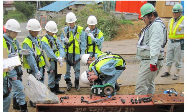
写真 10 ボルトキャリブレーション試験
