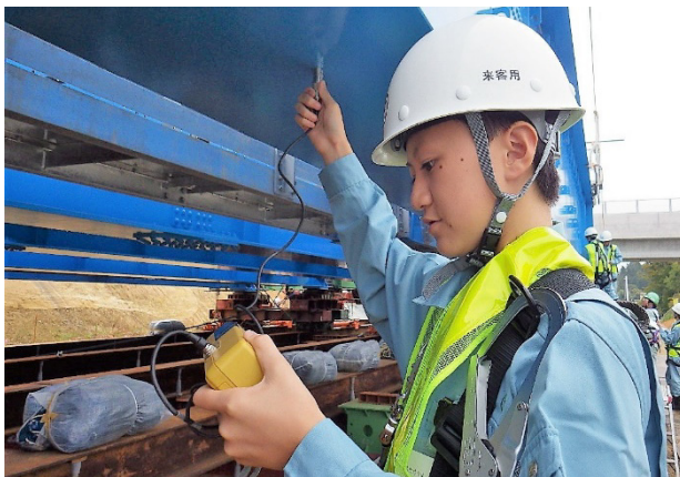
写真 9 塗装膜厚の計測体験
