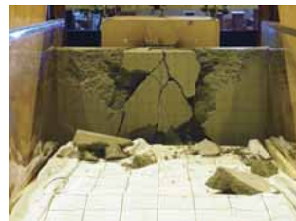
従来工法の壁高欄の破壊状況
