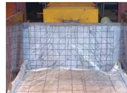
PCF壁高欄の破壊状況
